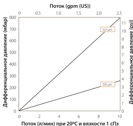
Для размера А при данной производительности разделите дифференциальное давление В на два.
