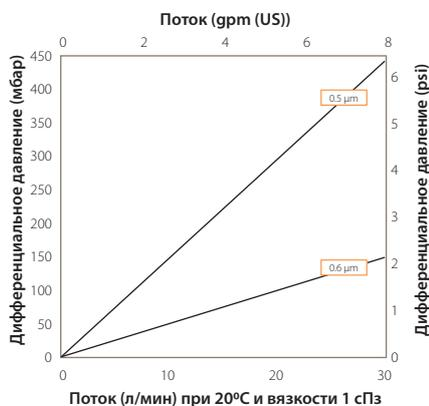
Для размера К при данной производительности умножьте дифференциальное давление 10" (250 мм) на два.
